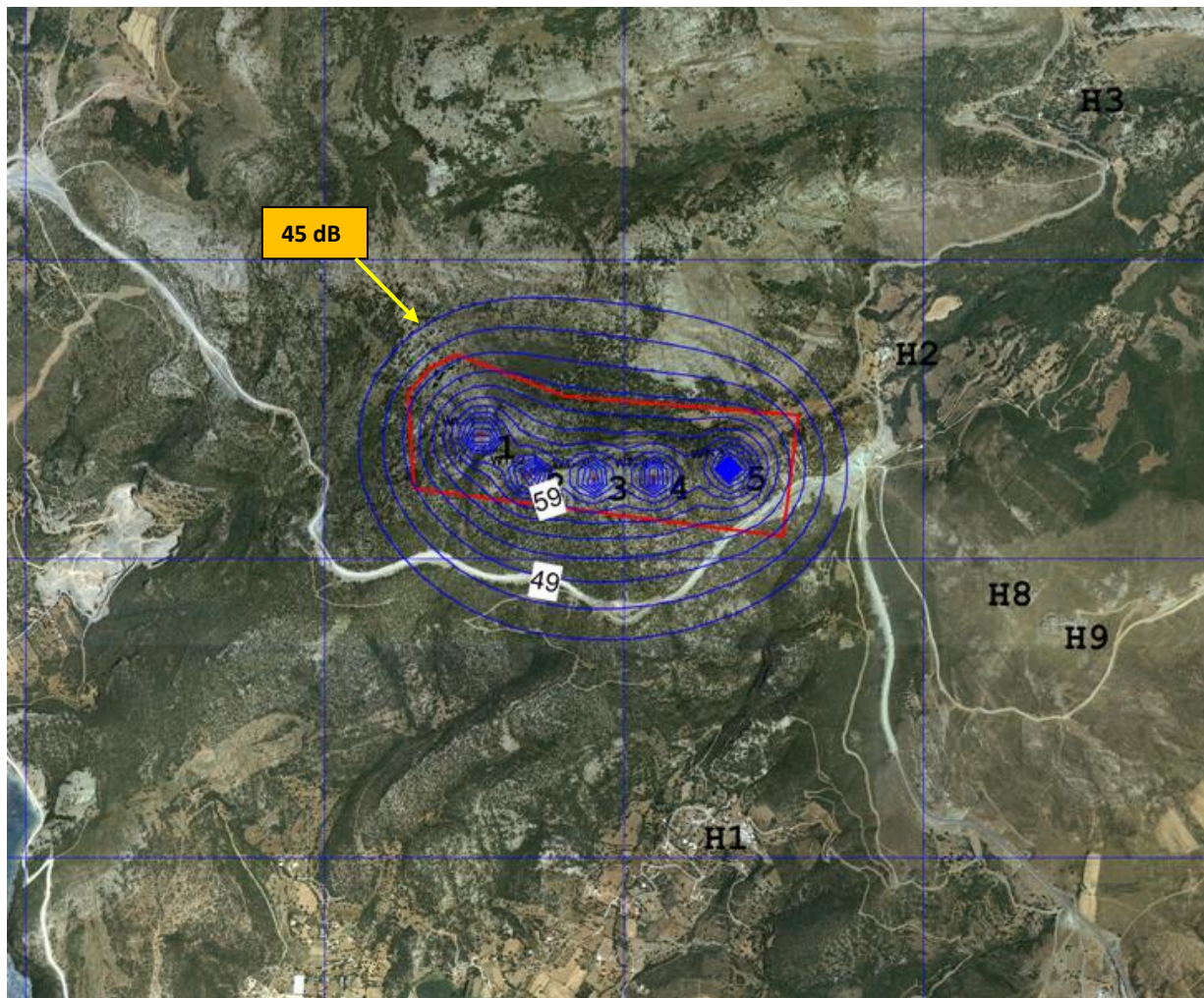
Σχήμα 4.1b: Ισοθορυβικές καμπύλες (μέχρι του ορίου των 45 dB) τοποθετημένες επί αποσπάσματος ορθοφωτοχάρτη ΚΛΙΜΑΚΑΣ 1: 5.000 της περιοχής εγκατάστασης του Α/Π ΤΡΙΚΟΡΦΟ.
